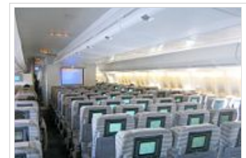
Clase económica en la cabina principal de un Boeing 747-400 de Japan Airlines con una disposición de 3-4-3 asientos por fila
